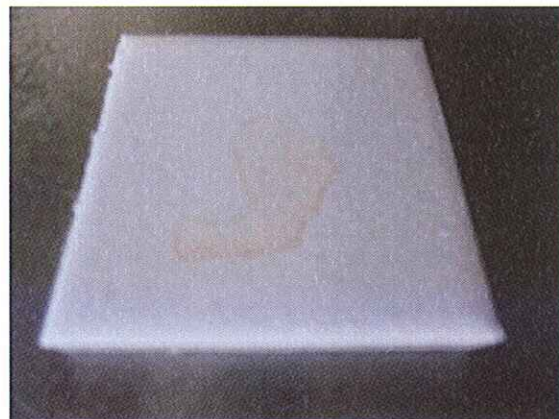
Foto 4: Eintrocknete Prüfsuspension auf der Testfläche nach 60 min. Trockenzeit unter der Laminar Airflow. (hier: C. albicans + RSA + Blut)
